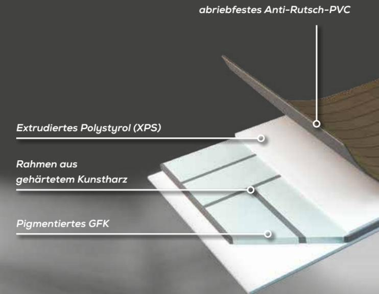
\*„schematische Darstellung“ bei Wand - und Bodenaufbau
